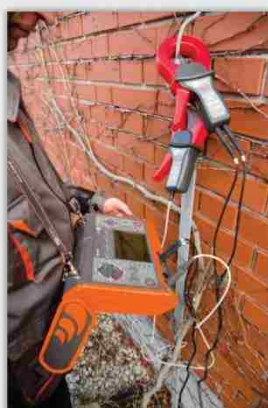
اندازه گیری مقاومت سیستم زمین و مقاومت لوب ارت ( R_{loop} ) به کمک دو کلمپ (3P+CLAMP)
